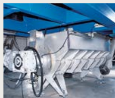
SISTEMA DI SCARICO DELLA FRAZIONE UMIDA
