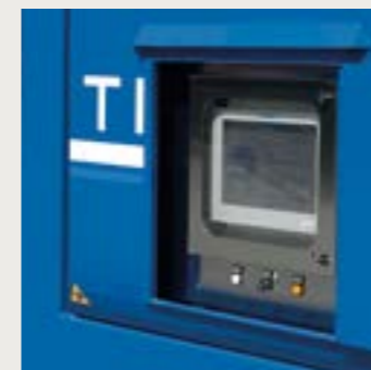
PANNELLO ELETTRICO INTEGRATO NEL TELAIO
